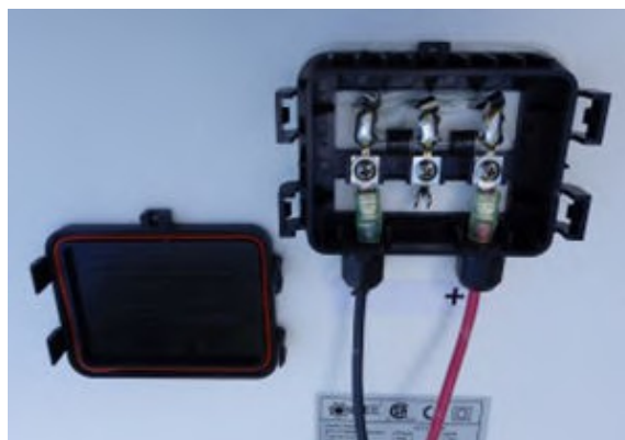
Rozvodná skříňka solárního panelu.
